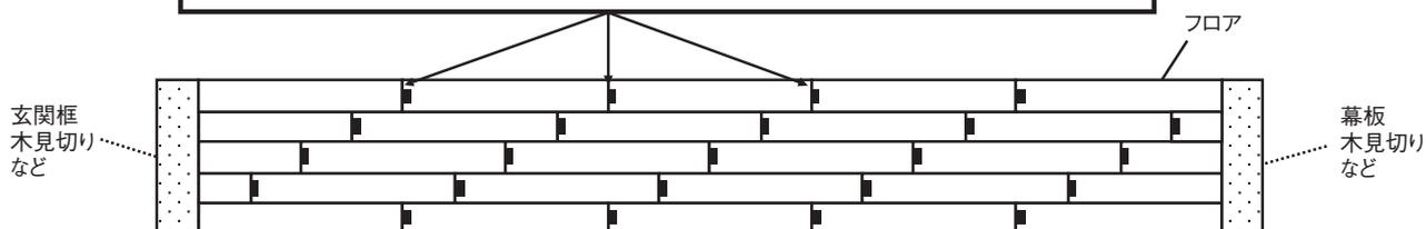
※フロアの巾カット時は、一旦、スペーサーをはずし、カット後のフロア寸法に応じて、適当な寸法にスペーサーをカットしてから、改めてフロアに取り付けて施工してください。
