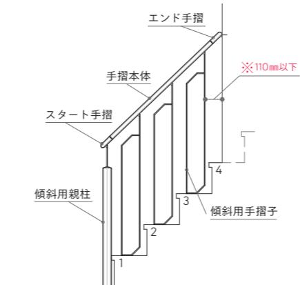
●階段手摺 直 14段上りきり [壁納め]
