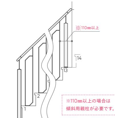
●吹抜け部手摺 1P 間口 (910) [階段手摺～壁納め]
