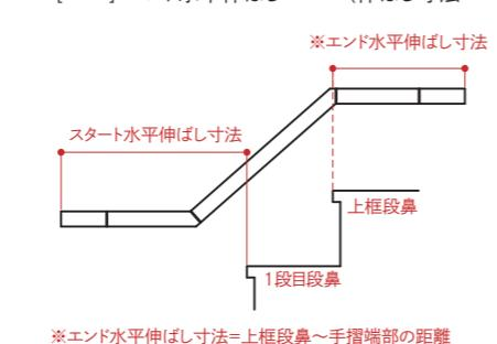
※エンド水平伸ばし寸法=上框段鼻~手摺端部の距離
