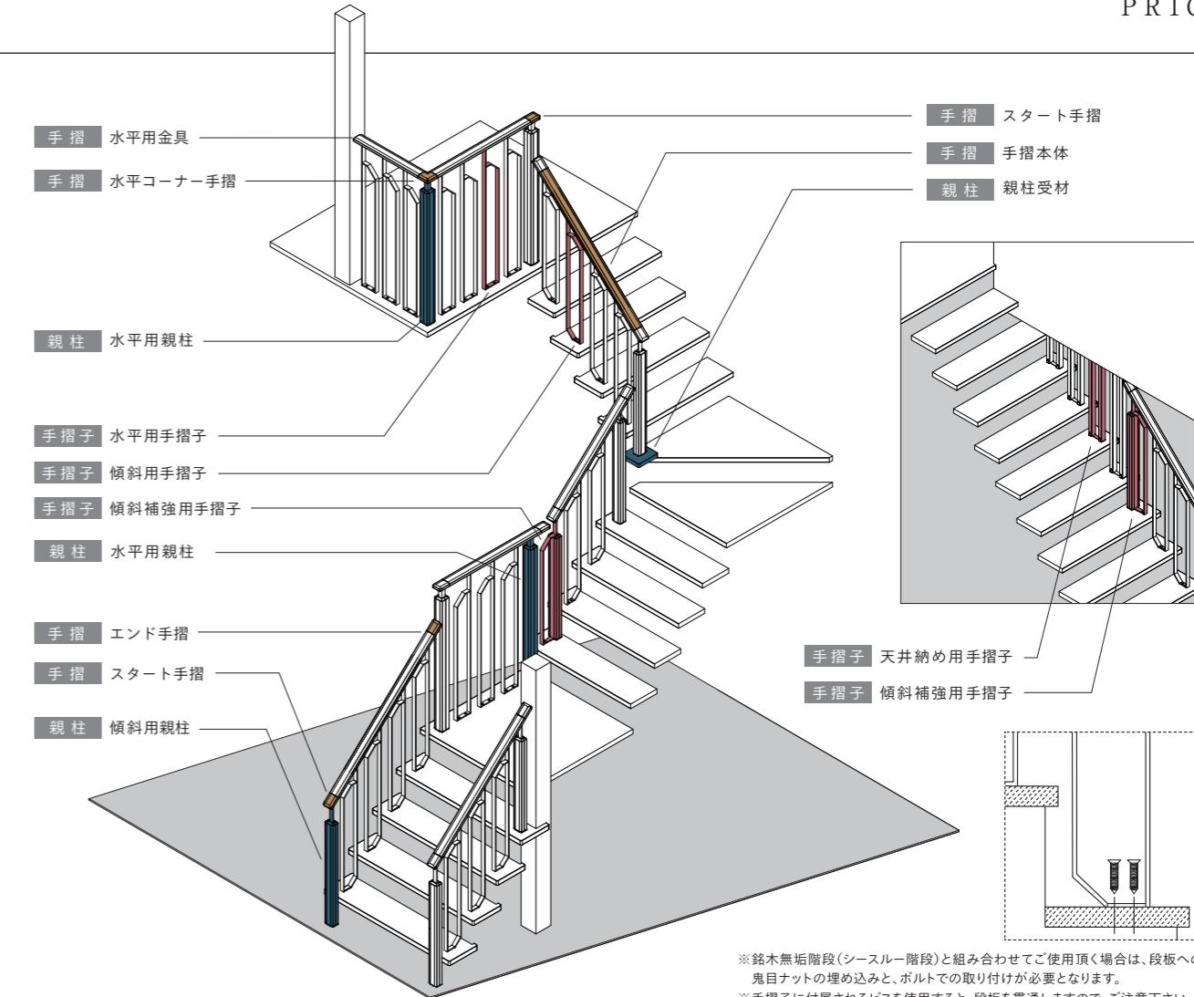
※銘木無垢階段(シースルーステップ)と組み合わせてご使用頂く場合は、段板への鬼目ナットの埋め込みと、ボルトでの取り付けが必要となります。
