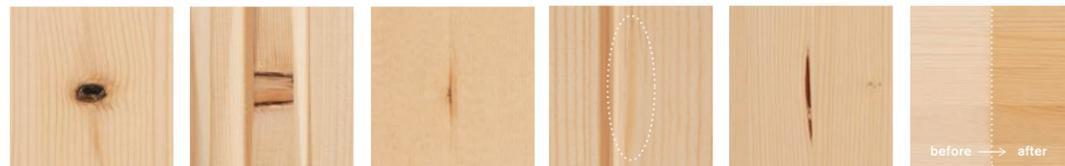
ノット・ピンノット 横節 バークポケット 埋め木 ガムポケット 経年変化
