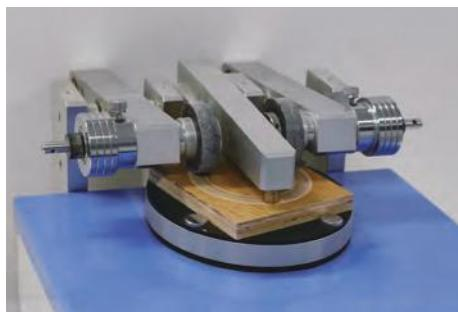
研磨紙に 1 kg の荷重を掛け、フロア表面を 1,000 回転させた後の、塗膜状態を評価する。
