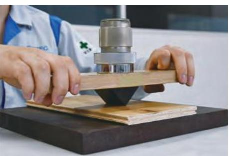
カーボンブラック配合黒ゴムに 2 kg の荷重をかけて、フロア表面を 15 往復させて、乾いた布でふき取る。ふき取り後の表面状態を評価する。
