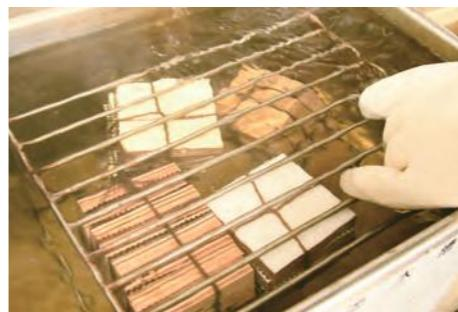
70°Cの温水中に 2 時間浸せきした後、60°Cで 3 時間乾燥させる。試験後のフロア表面の塗膜剥離状態を評価する。
