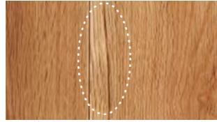
道管やその他の細胞中に堆積した炭酸塩などによって生じる暗色の筋をかなすじ(ミネラルストライク)と呼ぶ。
