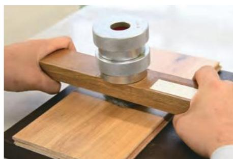
接地面積 9 cm<sup>2</sup>の載荷板にスチールウールを取り付け、2 kg の荷重を加え、フロア表面を 10 往復させた後の、塗膜の白化状態を評価する。
