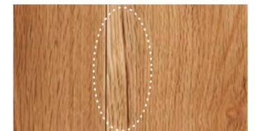
道管やその他の細胞中に堆積した炭酸塩などによって生じる暗色の筋をかなすじ(ミネラルストリーク)と呼ぶ。
