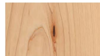
樹皮が傷ついたとき(キツキや虫などにつけられた傷口など)、その部分を癒やそうと巻き込むようにして新たな形成層が成長する。その痕跡として生じる筋やカスレたような色変わりをバークポケット(樹皮痕)と呼ぶ。
