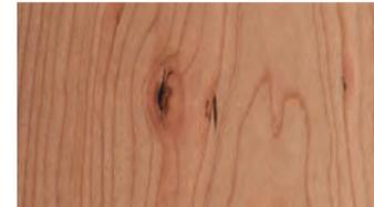
枝の根付け部分が幹に包み込まれてできたものをノット(節)と言い、その小さなものをピンノット(葉節)と呼ぶ。
