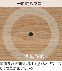
塗膜及び表面材が削れ、触るとザラザラして段差が生じている。
