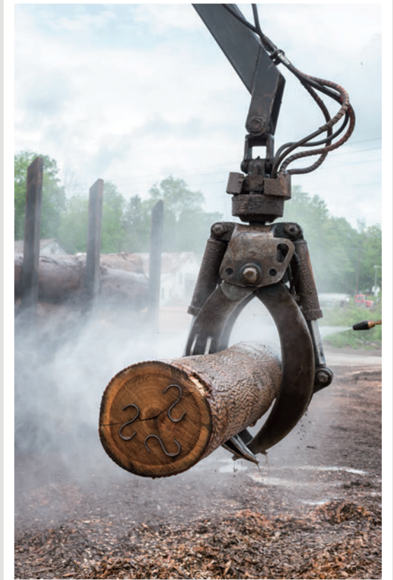
バーカー（はく皮機）に投入される丸太
