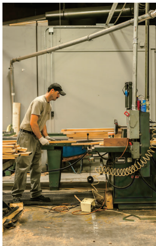
幅カットの工程
